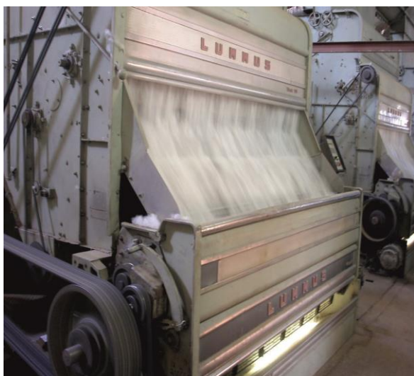
Les usines d'égrenage de l'UEMOA sont équipées avec des égreneuses à scie
