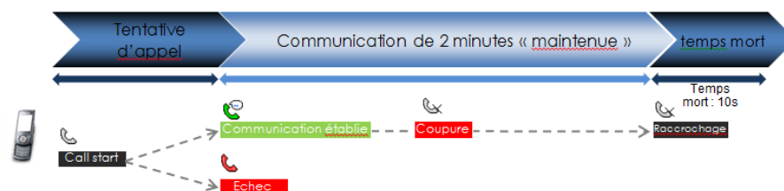
FIGURE 3 . PROTOCOLE DE MESURE QoS VOIX
